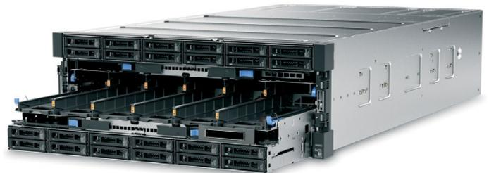
Obere und untere Rechenschächte gleiten für einfache Upgrades und Wartungsarbeiten aus der Vorderseite des Gehäuses
